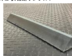
<板厚36mm 表45° 切断サンプル>
