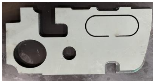
<板厚16mm 造船向け形状切断サンプル>
