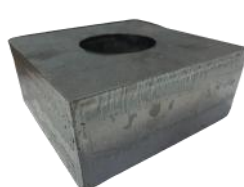
<板厚50mm I-CUT切断サンプル>
